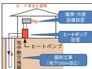
◀地中熱ヒートポンプシステム導入のイメージ（クローズドループ方式）
